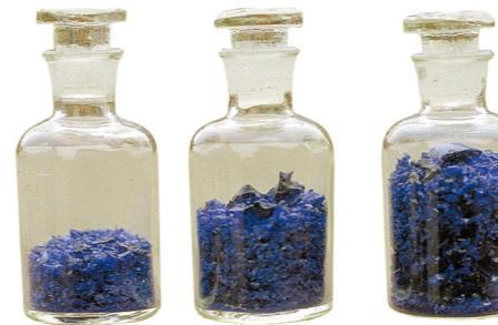
太极自行研制的TJ09瓷釉的性能已经达到国际先进水平。在抗酸、碱腐蚀、机械冲击, 耐温急变及耐磨蚀方面, 均有卓越的性能。它可以抵抗除氢氟酸和浓磷酸之外的一切有机酸、无机酸、有机溶剂及弱碱等介质的侵蚀。
