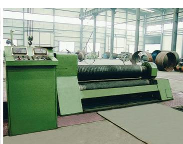
四辊液压卷板机，最大卷压厚度 50mm
