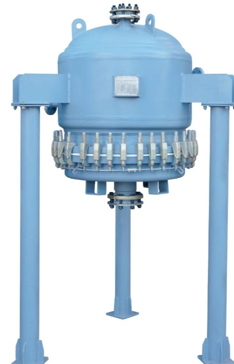
搪玻璃过滤机，被广泛应用于腐蚀物料的固液分离，尤其在有毒介质、易燃易爆的介质及避免与空气接触介质的固液分离。它可以在全真空或最大正压6kg下工作。设备的夹套可以根据需要对滤液进行加热或冷却。过滤机的底部，可以采用液压升降装置，来帮助清除滤饼和更换滤布。
