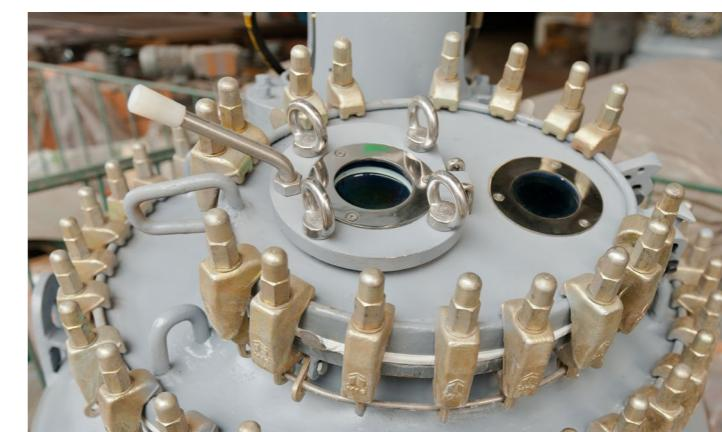
带烧结视镜型人孔装置，此结构是上一代人孔装置的升级产品。该结构更适用于安装在使用CIP清洗系统的生产线。由于视镜玻璃和人孔盖在高温下烧结成一体，使视镜玻璃更容易清洗。加之采用快开手孔装置，使手孔盖的开启更方便，更快捷。
