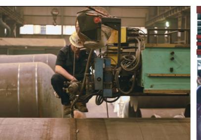
自动埋弧焊接装置
