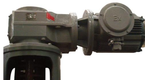
斜齿轮减速机，采用最优化，模块化的设计理念，具有体积小、重量轻、传递转矩大、起动平稳、传动比分段精细等特点，可根据用户要求选择不同的安装位置。齿轮采用优质高强度合金钢，表面渗碳硬化处理，承载能力强，经久耐用。
