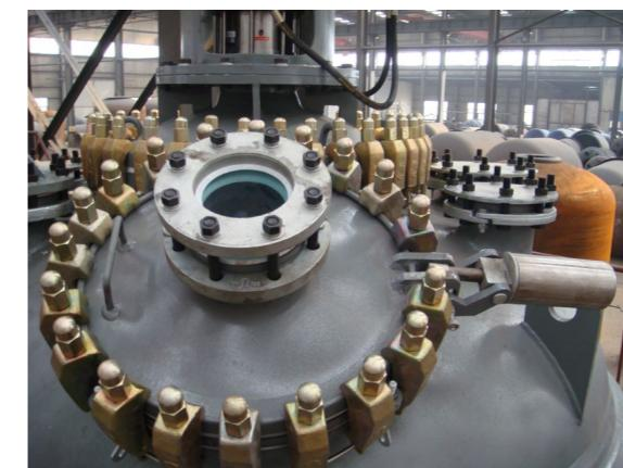
此人孔装置，带有保护环和弹簧辅助开启装置，可比较容易的装配在搪玻璃反应釜上，利用弹簧的作用，可方便地打开和关闭。保护环装置可避免投料时对釜盖人孔的磨损和碰伤。
