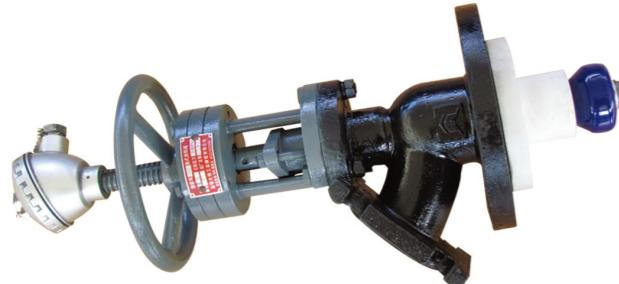
这种放料阀是搪玻璃反应罐专用的底部放料阀，它的阀体是由铸铁或铸钢制造的。在阀体的内表面及阀芯外表面均有搪玻璃，阀芯的密封是通过压紧聚四氟乙烯密封环来实现的。这种阀门分为上展式和下展式两类。
