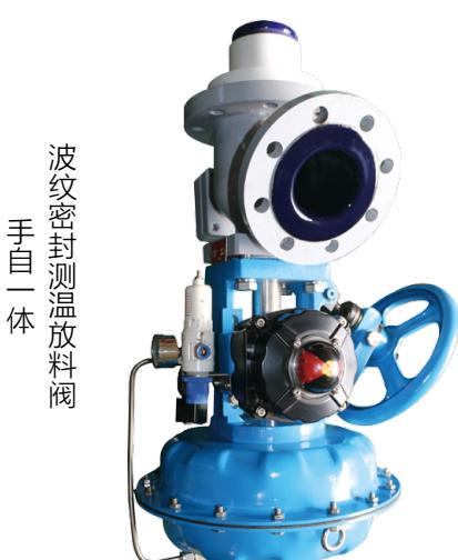
搪玻璃搪瓷波纹管密封型放料阀，是填料密封型放料阀的替代产品，具有密封性能可靠，清洗方便，可承受更高的操作压力等特点。阀体采用冲压成型的方式，材料强度大大提高。使用温度范围：-19℃~200℃。工作压力：0.6~1.6Mpa。
