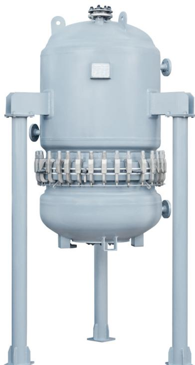
搪玻璃过滤机，被广泛应用于腐蚀物料的固液分离，尤其在有毒介质、易燃易爆的介质及避免与空气接触介质的固液分离。它可以在全真空或最大正压6kg下工作。设备的夹套可以根据需要对滤液进行加热或冷却。过滤机的底部，可以采用液压升降装置，来帮助清除滤饼和更换滤布。
