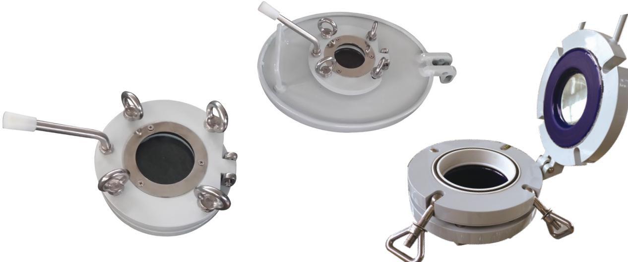
带烧结视镜型人孔装置，此结构是上一代人孔装置的升级产品。该结构更适用于安装在使用CIP清洗系统的生产线。由于视镜玻璃和人孔盖在高温下烧结成一体，使视镜玻璃更容易清洗。加之采用快开手孔装置，使手孔盖的开启更方便，更快捷。
